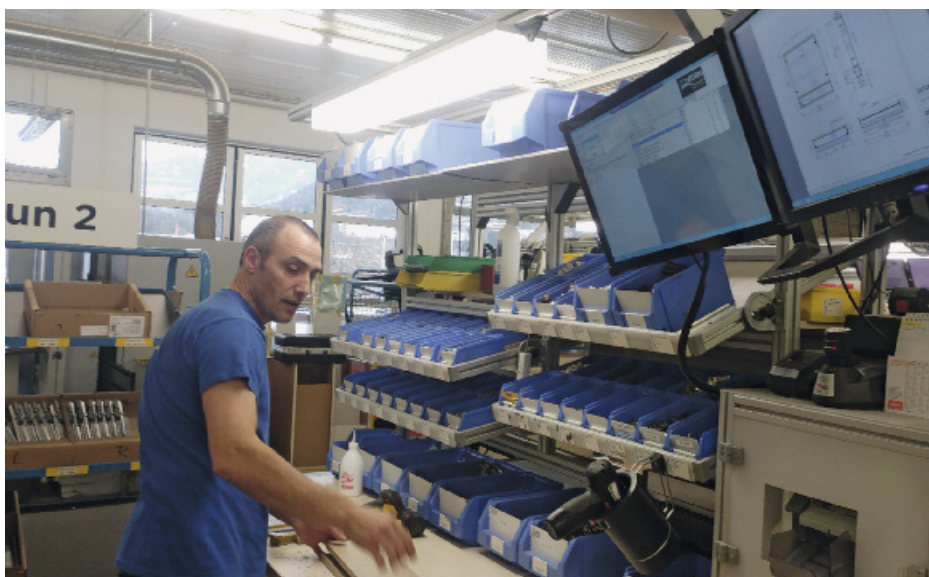
Smarte Möbelfabrik, jede Arbeitsstation ist mit Bildschirmen versehen, die von jedem Bauteil die Vorarbeiten und weiteren Schritte dokumentieren. (FN/SAB)
