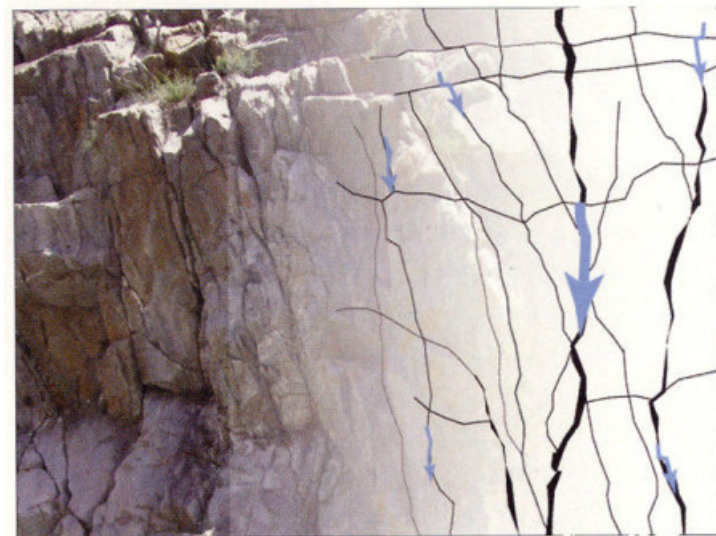
Fliesswege des Grundwassers im geklüfteten Gestein
