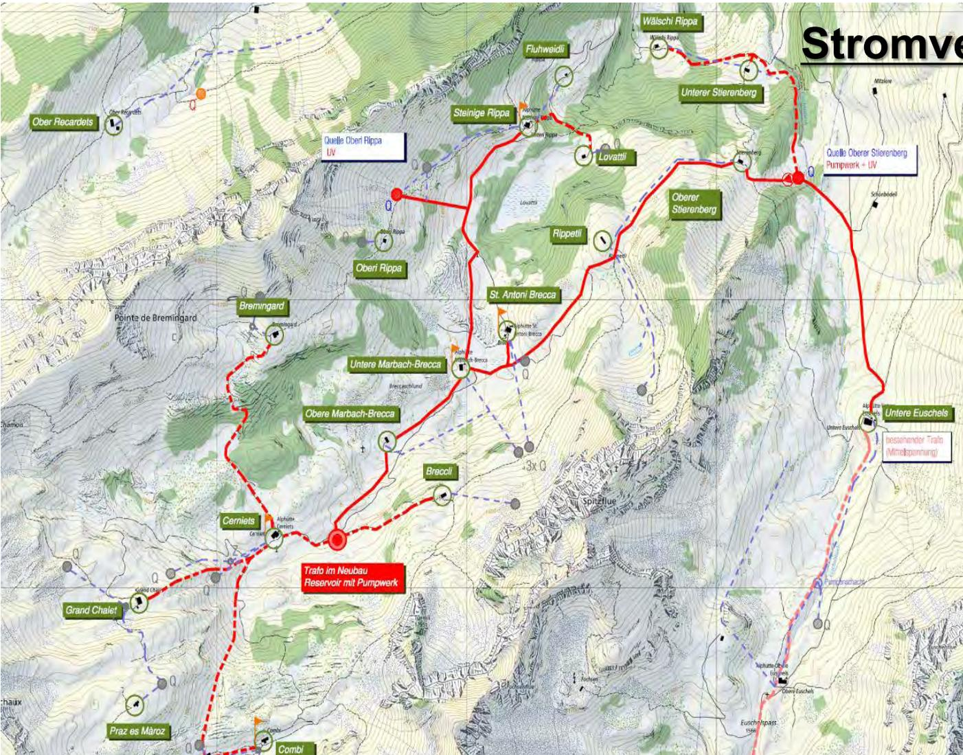
Stromversorgung ist für Pumpwerke, UV-Anlagen bei Quellen und Reservoir notwendig ! Die Hauptalpen werden am Strom angeschlossen.
