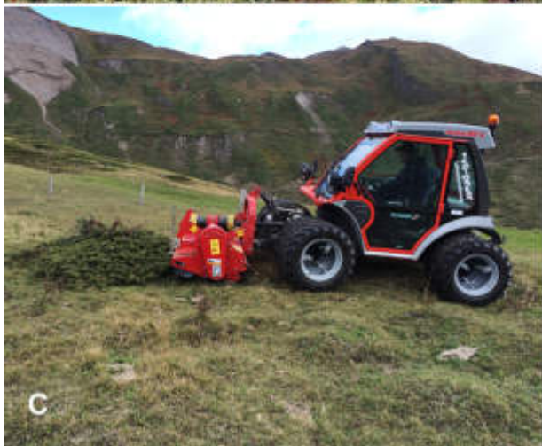
Abb. 2 : A: geschlossene Zwergstrauchheide vor dem Eingriff im Herbst 2017. B: Einsatz des Metracmulchers auf Fläche A im Herbst 2017. Für die maschinelle Zwergstrauchreute im Gebiet Hanschbiel eingesetzte Mulchertypen. C: Metracmulcher, D: Raupenmulcher.
